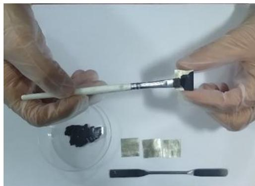
Рисунок 7 – Процесс нанесения суспензии с помощью кисточки
